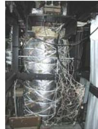
1. Champ magnétique induit mesurée à l'aide de sonde à effet Hall et fluxgates.
