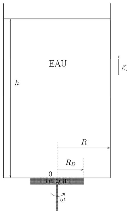
FIG. 1 – Schéma de principe du tourbillon expérimental.
