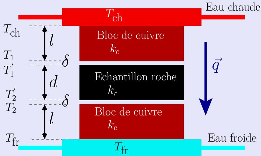
On mesure avec des *thermocouples* les températures  $T_{fr}$ ,  $T_2$ ,  $T_2'$ ,  $T_1$ ,  $T_1'$  et  $T_{ch}$  et on constate qu'après un temps transitoire, ces températures restent demeurent stationnaires.
